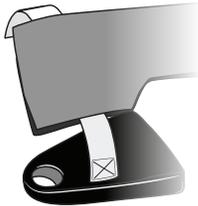
2. Attachez les sangles Velcro blanches aux barrières du lit chirurgical en les enroulant sous la barrière et en attachant les extrémités du Velcro ensemble. (*Figure 3*)
